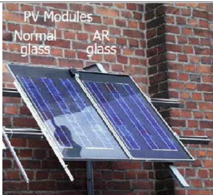
Figura 10: Le due immagini dimostrano in modo lampante come, al contrario di un vetro comune (normal glass), il vetro anti-riflesso (Anti-Reflecting glass) che riveste i moduli fotovoltaici (Photo Voltaic Modules) riduca drasticamente la riflessione dei raggi luminosi.
